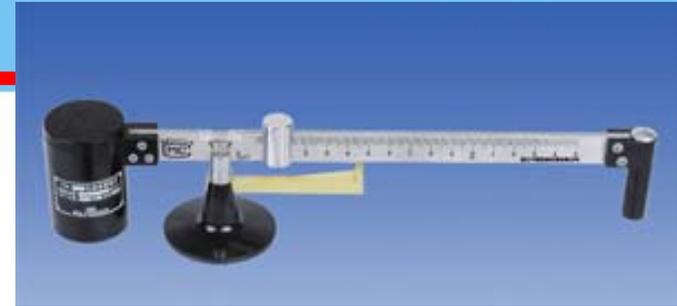
▲ 调节泥浆柱压力- $\rho \uparrow$ ，对井底和井壁的压力越大
