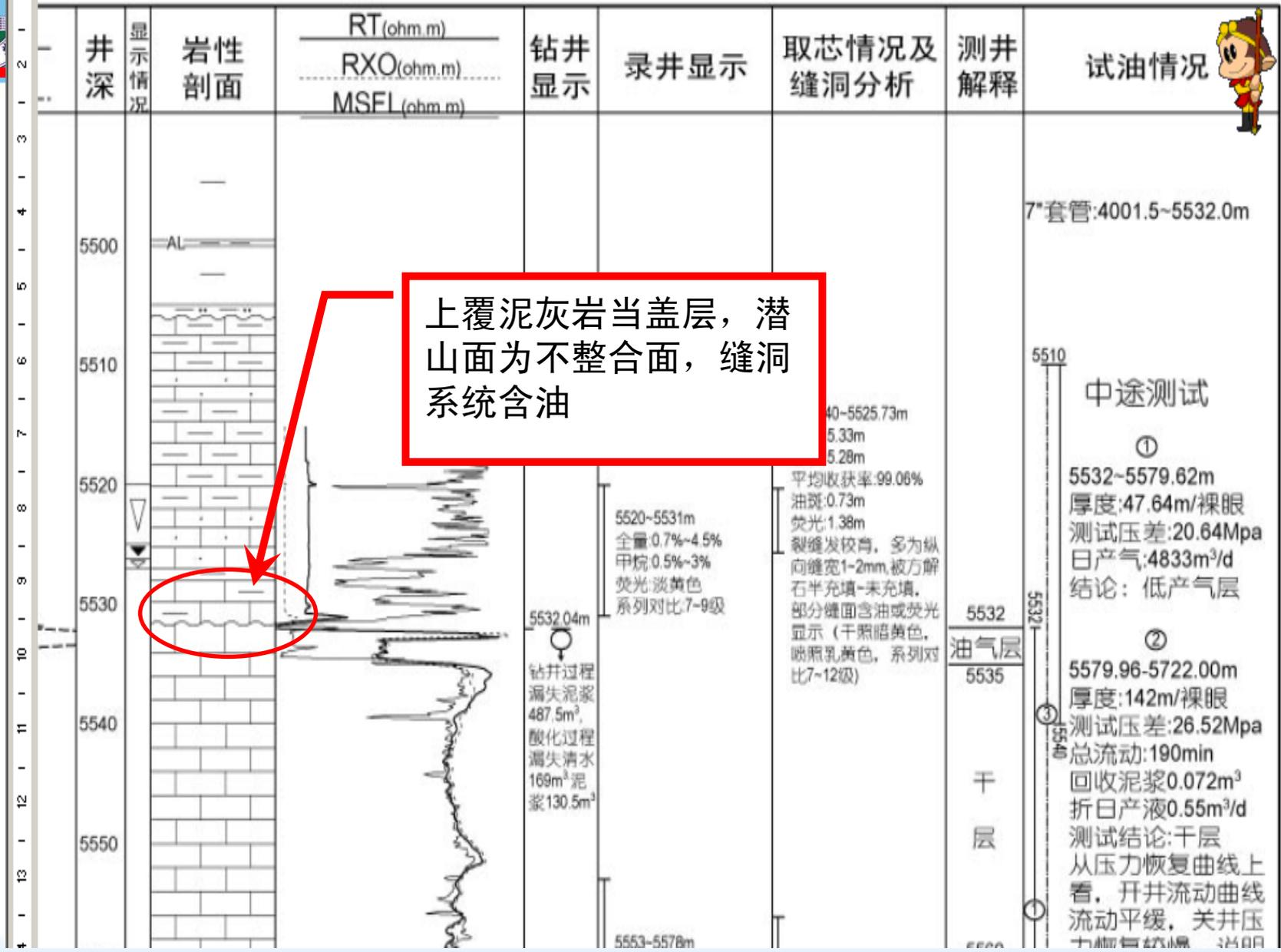
上覆泥灰岩当盖层，潜山面为不整合面，缝洞系统含油
